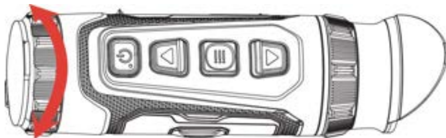
Figura 3-2 Ajuste del enfoque
