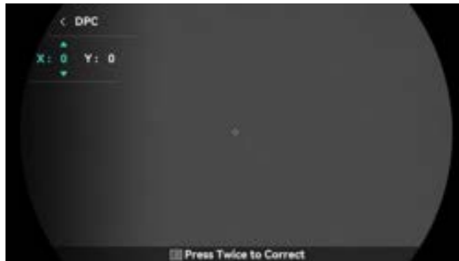
Figura 3-6 Corrección de píxeles defectuosos
