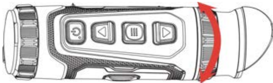
Figura 3-1 Ajuste de la dioptrías
