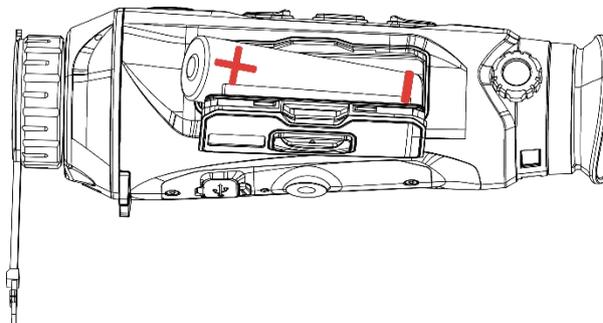
Figura 2-2 Insertar la pila
