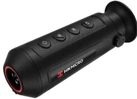
EL MONOCULAR TÉRMICO HIKMICRO LYNX S LE10S está equipado con un detector de infrarrojos de  $256 \times 192$  y una pantalla OLED de  $800 \times 600$ . Admite funciones de observación, medición de distancia, punto caliente, etc. El detector térmico incorporado de alta sensibilidad le proporciona una visión clara incluso en la oscuridad total. El monocular se aplica principalmente a escenarios como la caza, el senderismo, la búsqueda y rescate, etc.
