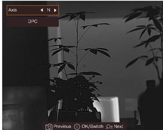
**Figura 3-4 Corrección de píxeles defectuosos**
