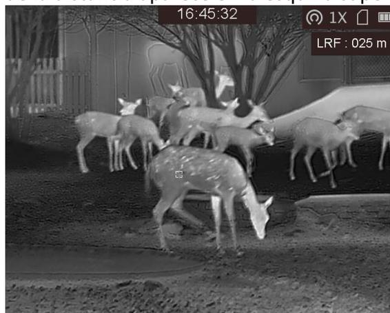
Figura 6-1 Resultado de la medición de distancia
