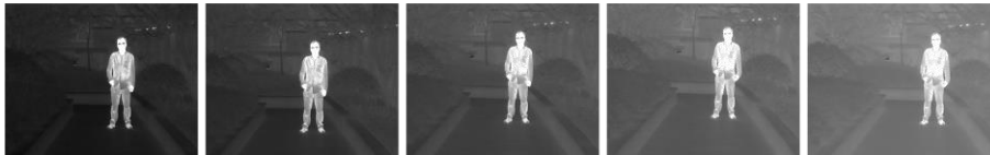
Figura 3-4 Ajustar el brillo en el modo blanco caliente
